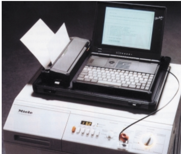
Das Update geschieht über eine optische Schnittstelle auf der Bedienblende
